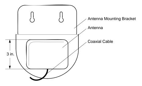
Figure 1-6. Wall Antenna
